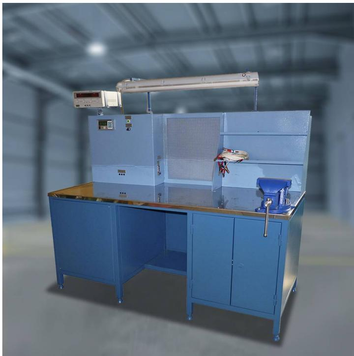
**Специализированное рабочее место по ремонту электрической аппаратуры с комплектом измерительного оборудования (ТО СРМ)**
