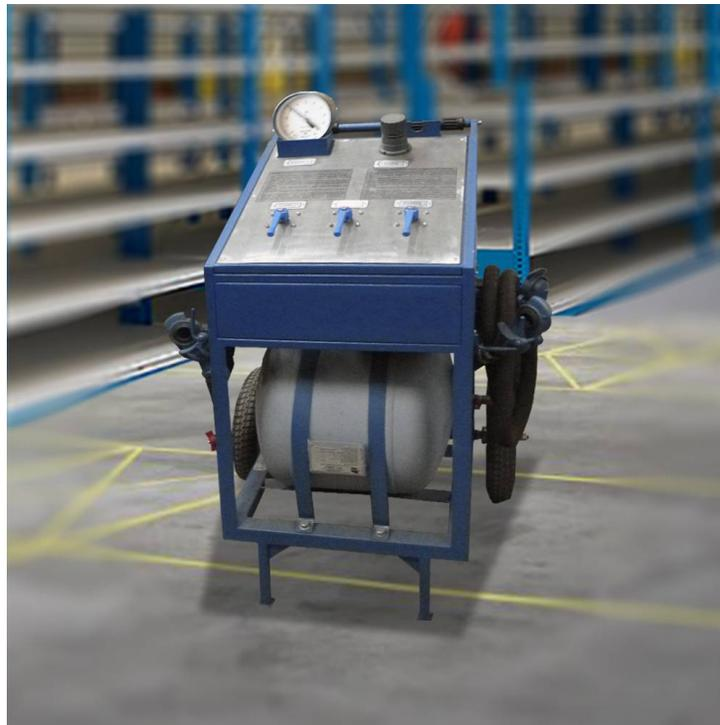
**Установка проверки тормоза вагона мобильная (УПТВМ)**
