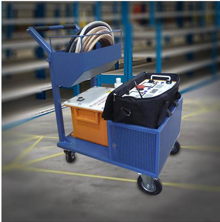
**Установка передвижная пробивная на 10кВ**
