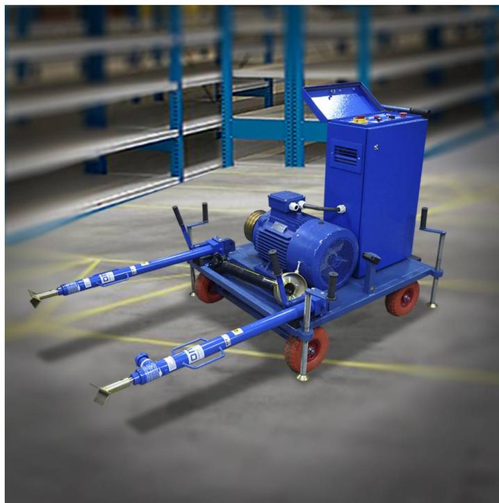
**Установка прокрутки подвагонных генераторов (УПГ)**
