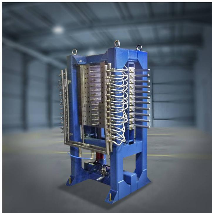
**Установка для опрессовки, проверки на пробой и межвитковое замыкание секций катушек якорей тяговых электродвигателей и тяговых генераторов**
